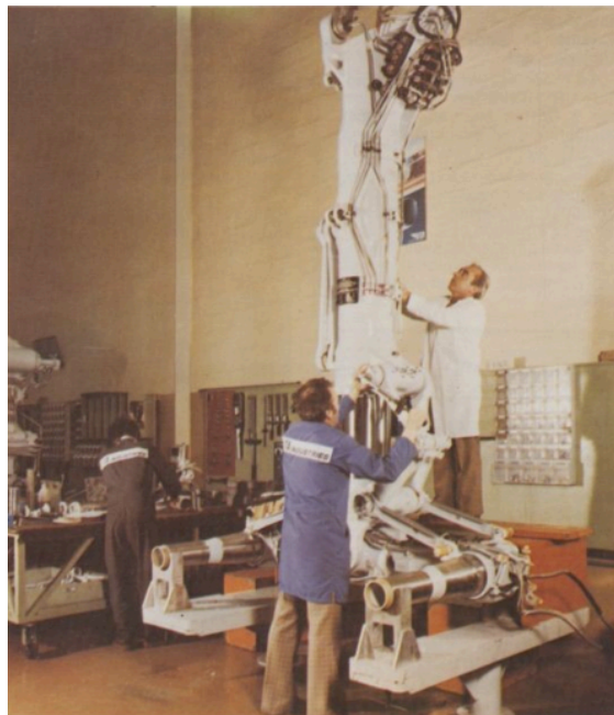
Train d'atterrissage DC 10 en cours de montage
