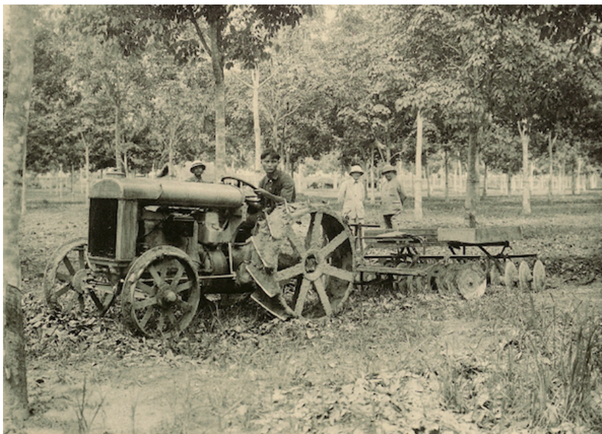
Planche 53. — Défrichement : dessoucheuse en fonctionnement
