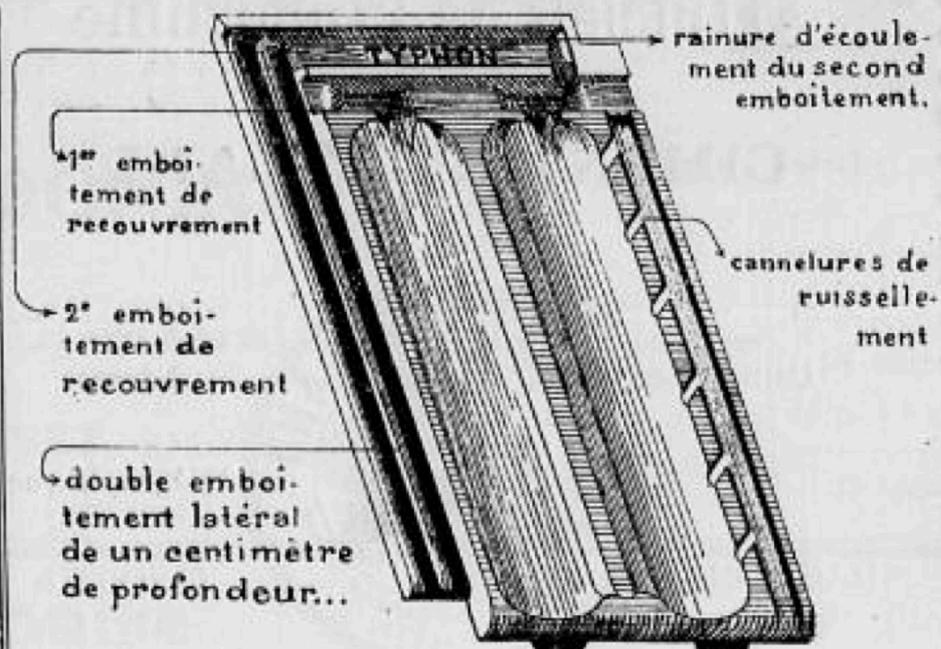
15 au mètre carré, double emboîtement, double recouvrement, crochet extra-résistant pour les attaches au fil de fer. — Poids 42 kgs au m<sup>2</sup>.
