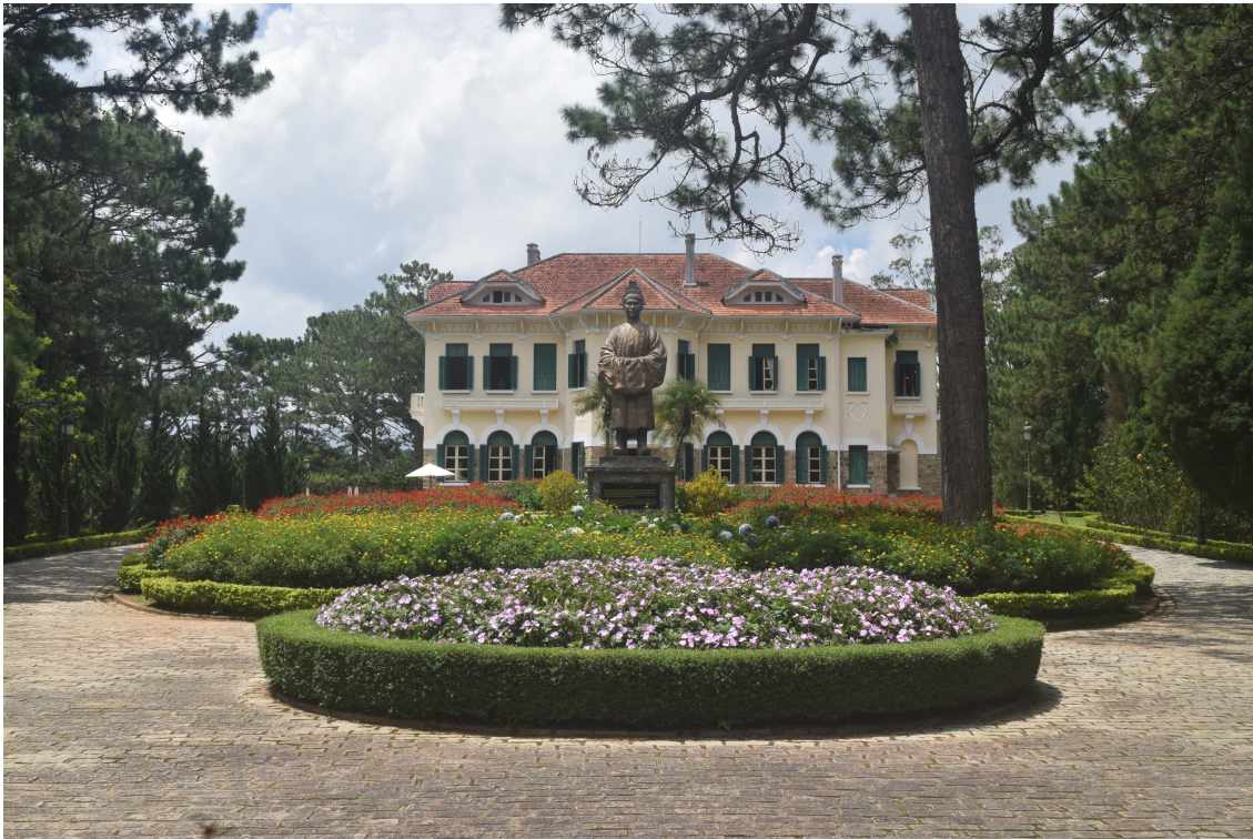
Villa rectangulaire avec pignons cassés latéraux, chiens assis cassés (fenêtres de toit), aisseliers pour soutenir l'avancée du toit et bow window à l'avant comme à l'arrière.
